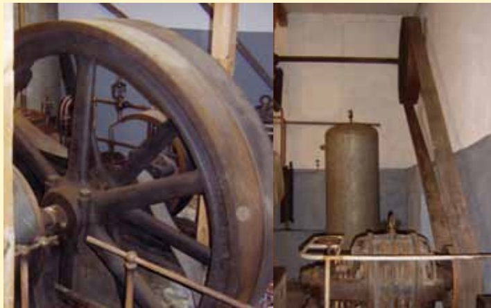
Der Antrieb der Kohlensäuregas-Verflüssigungsanlage erfolgte über eine Transmission und große Schwungräder.
